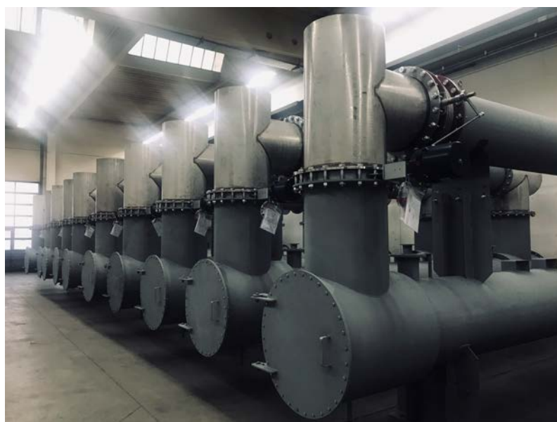
На рисунке показаны первые 10 теплообменников отработавших газов со встроенным байпасом, перед отправкой из нашего завода в г.Гунценхаузене.
